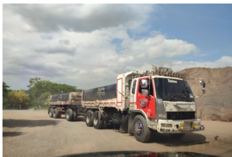
ภาพที่ 8-6 รถบรรทุกทุกคันปิดคลุมให้มิดชิดก่อนออกสู่ภายนอกโครงการและป่อฉีดล้างล้อรถก่อนออกสู่ ถนนลาดยางทางหลวง 21
